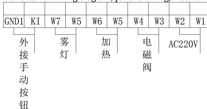
GCWD-2型雾笛控制器外部接线图
